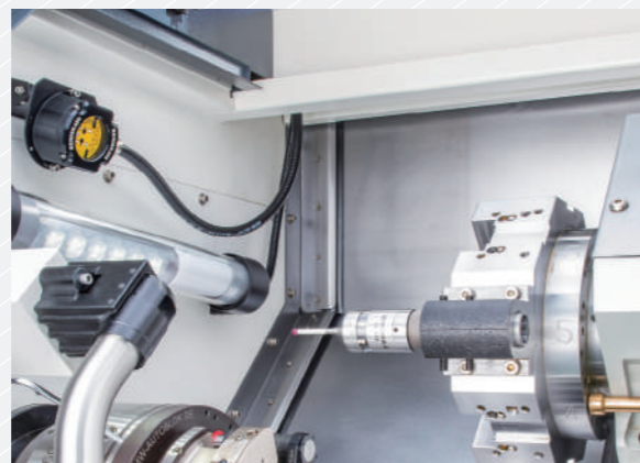
工件測量系統 自動測量和校正尺寸
