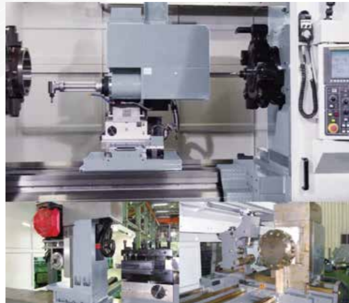
兩把刀架配備不同的設備，如：Y軸的銑削/Y軸的驅動刀具刀塔/不同的刀塔/用於加工的磨削設備。我們擁有豐富的客製化經驗，製造更符合客戶需求的機器是我們的專業。
